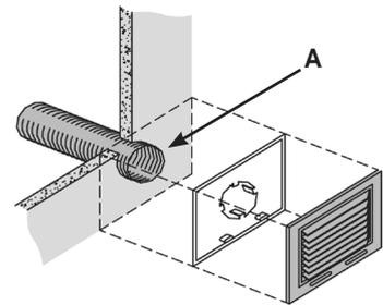
Il est important de sceller les bouches (**A**) dans le mur avec du silicone, de manière à éviter un passage d'air qui noircirait le mur sur leurs bords, à cause de la chaleur (par exemple, les moustaches de radiateurs).
