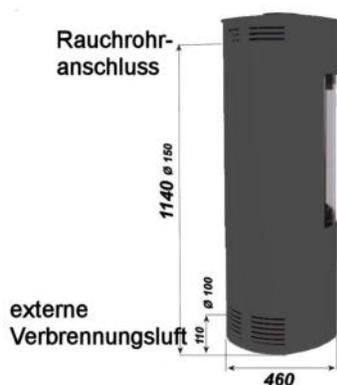
Les poêles à bois de type 1 décrits dans ce manuel sont certifiés selon la norme DIN EN 13240. Les poêles à bois de ce type peuvent être reliés à des cheminées à occupation multiple, dans la mesure où les dimensions de la cheminée le permettent. La norme DIN 4705, partie 3 est à respecter.
